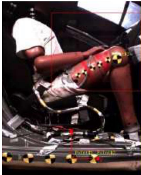
Slika 11. Prikaz testiranja područja koljena, [38]
