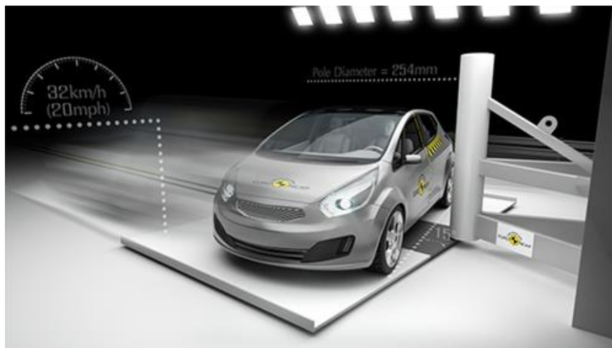
Slika 10. Prikaz bočnog udara u stup, [11]
