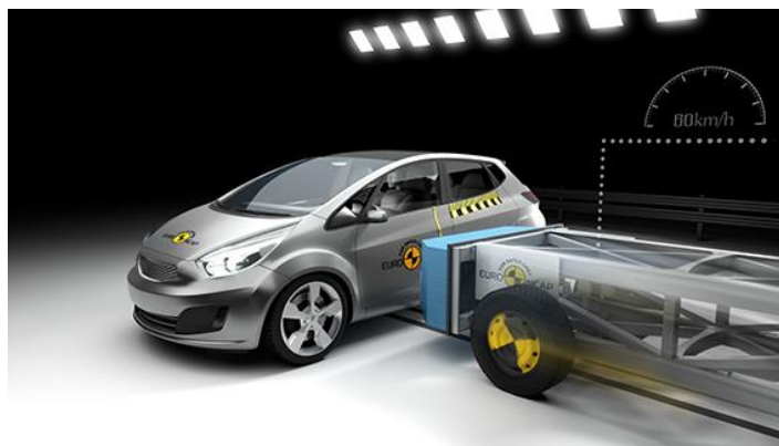
Slika 9. Prikaz bočnog sudara s pokretnom deformabilnom barijerom, [10]
