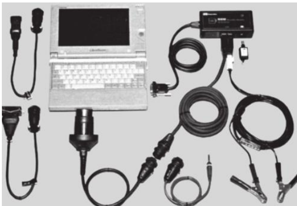
Slika 30. Programni skener s osobnim računalom
