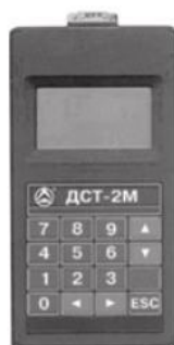
Slika 29. Programni skener DST-2M (Rusija) bez osobnog računala
