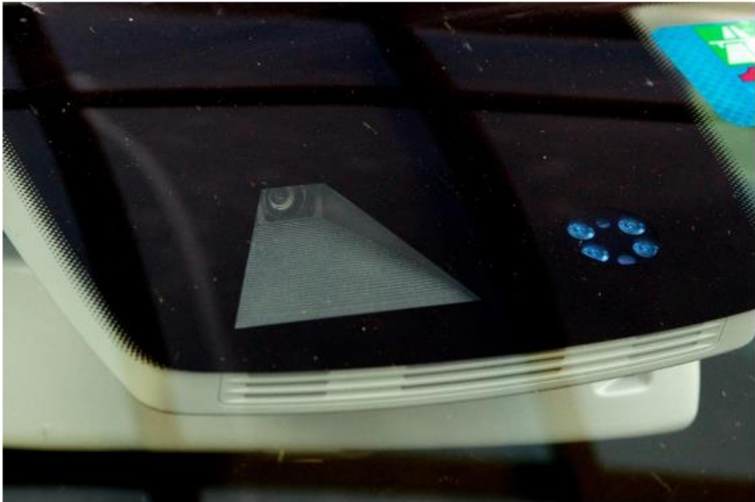
Slika 9. Predodžba kamere LDWS-a na VW Golfu [12]
