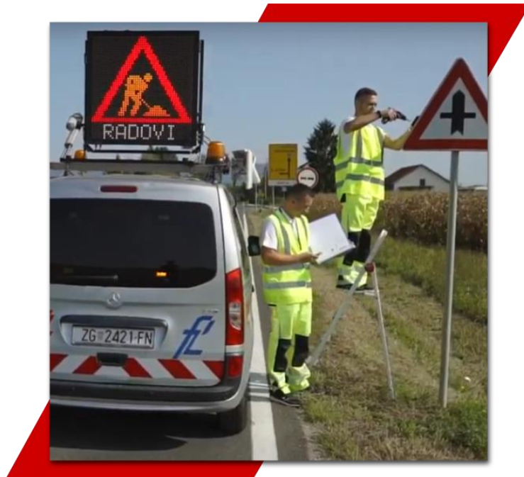
Slika 25: Očitavanje znakova RFID čitačem
