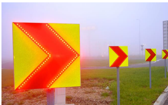
Slika 12. Prometni znak K-10 s ugrađenim svjetlosnim elementima, [16]
