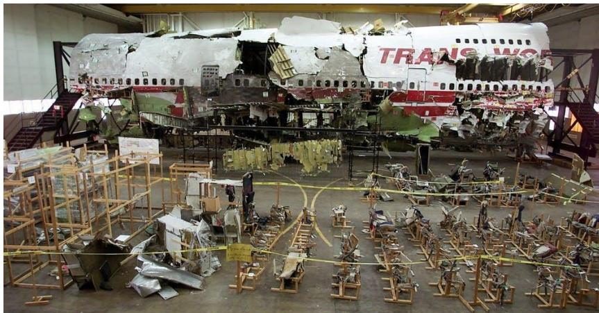
**Slika 2.** 3D rekonstrukcija olupine zrakoplova. Izvor: [9]
