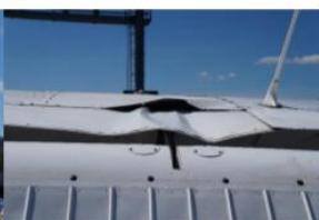
Slika 2 – Oštećenje oplate krila
