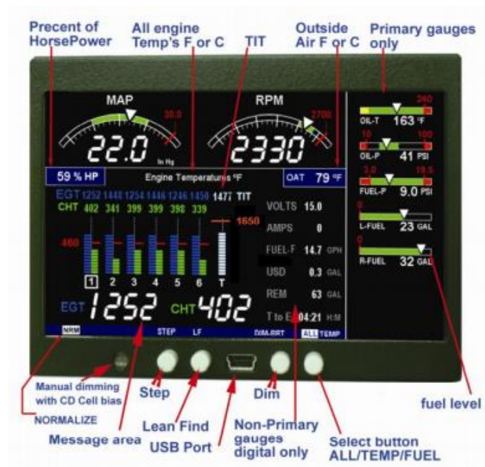
Slika 6. Horizontalni izgled i dijelovi prikaznika [6]
