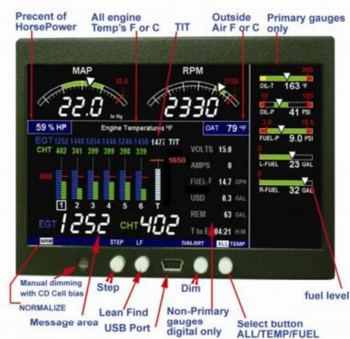
Slika 6. Horizontalni izgled i dijelovi prikaznika [6]
