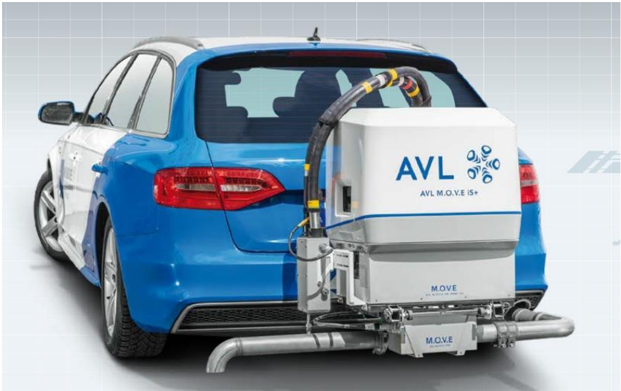
Slika 14 PEMS sustav postavljen na cestovnom vozilu [8]
