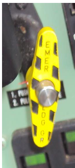
Slika 14. Izgled ručice za izvlačenje podvozja u slučaju nužde – PC-9M
