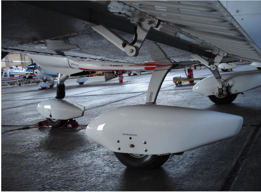
Slika 6. Čelične opružne noge na zrakoplovu Zlin 242L
