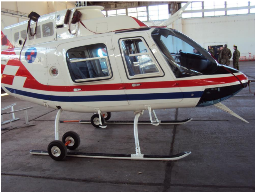
Slika 5. Podvozje tipa "skije" helikoptera Bell 206B
