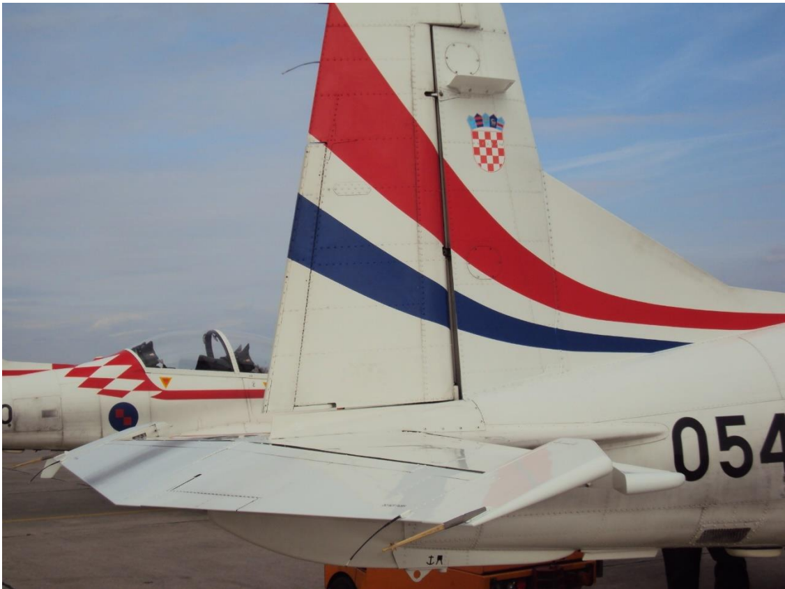
Slika 5.2. Kormilo dubine i kormilo pravca na zrakoplovu PC-9M
