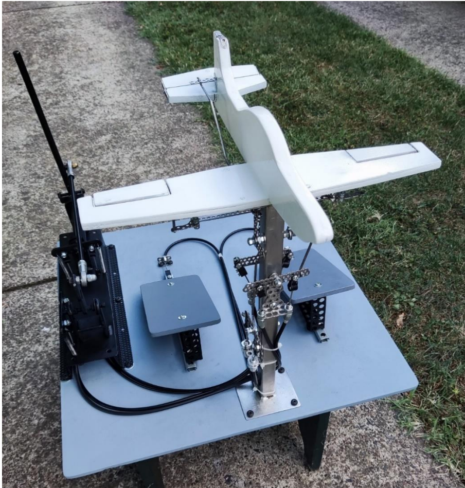
Slika 10.7. d) Potpuno dovršeni model upravljačkih površina zrakoplova
