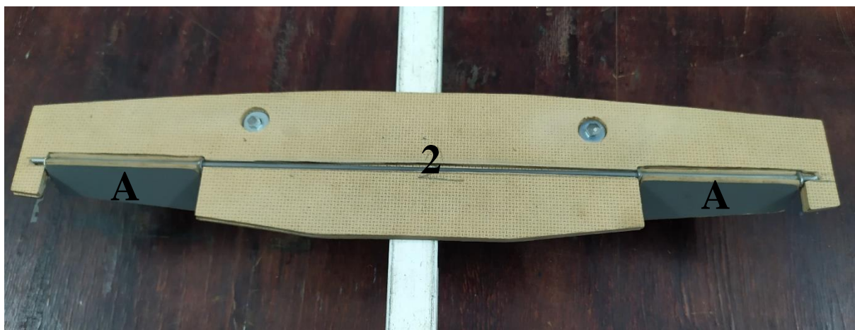
Slika 10.2. b) Krilo aviona bez gornje ploče
