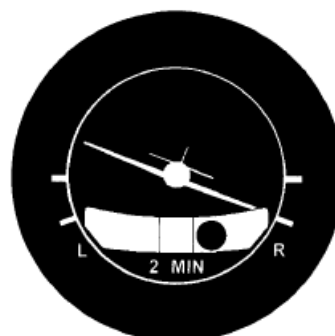
Slika 8. Avion u desnom nekoordiniranom zaokretu Izvor: [2]
