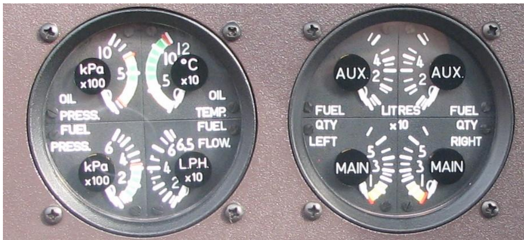
Slika 11. Četverostruki prikaznik parametra motora (lijevo) i prikaznik količine goriva (desno)
