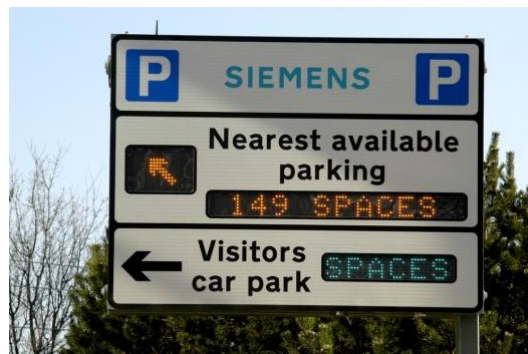
Slika 34. Sustav informiranja sudionika u prometu o slobodnim parking mjestima
