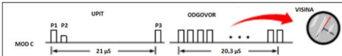
Slika 177. Princip rada moda C [18]
