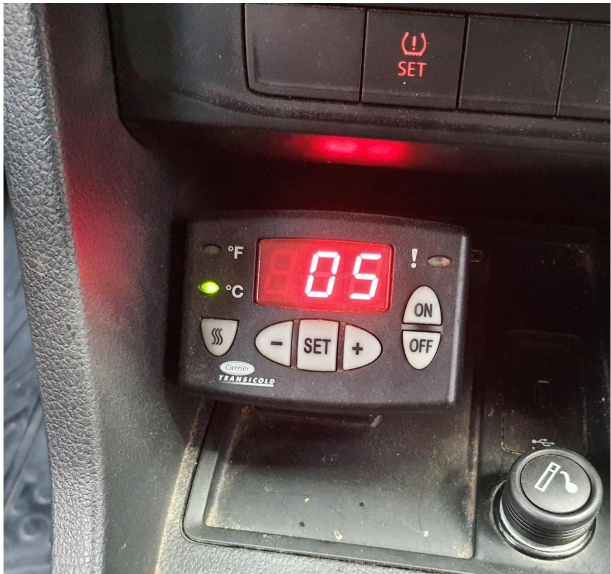
Slika 6 Računalo za praćenje temperature u hladnjači
