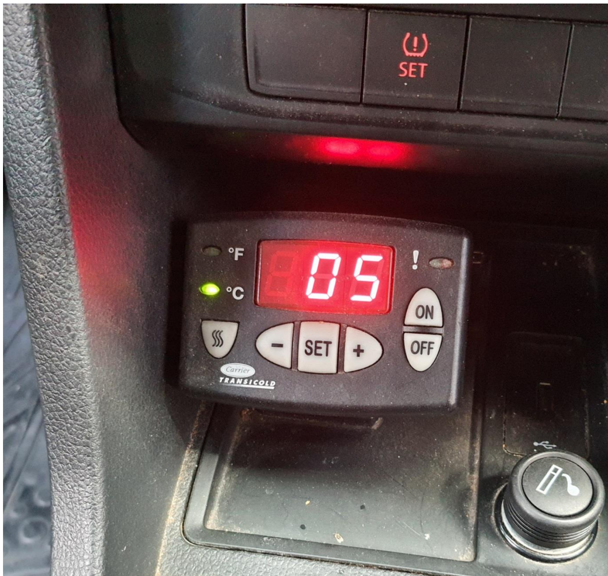
Slika 6 Računalo za praćenje temperature u hladnjači
