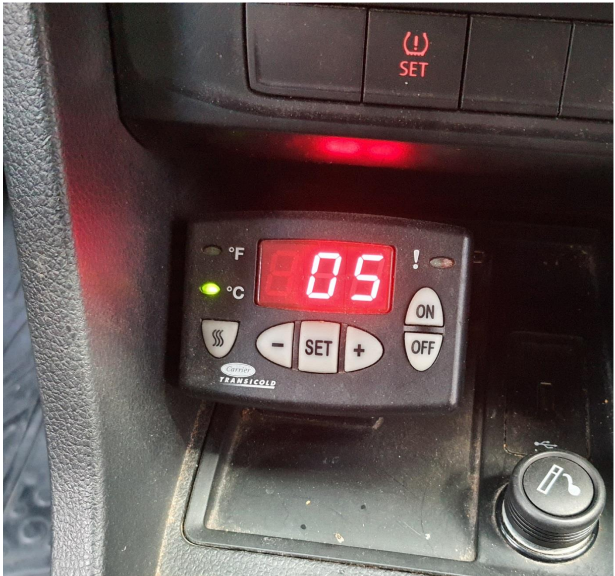
Slika 6 Računalo za praćenje temperature u hladnjači
