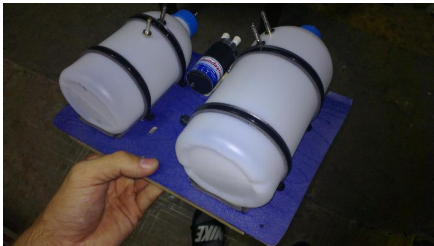
Slika 35. Konzola sa spremnicima za gorivo i ulje
