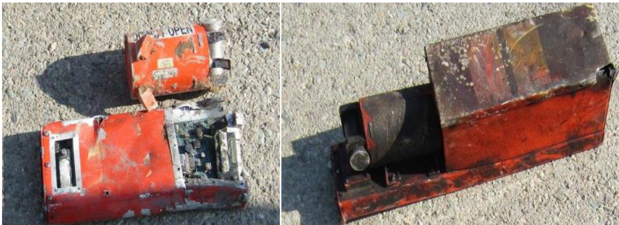
Slika 11. Izgled FDR i CVR nakon nesreće, [29]
