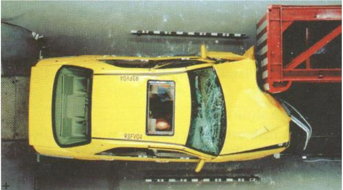
Slika 2-19 Bočni pomaknuti frontalni sudar (50 % prekrivanja), [2]
