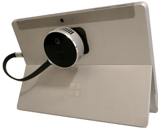
Slika 5-9 Prikaz LiDAR senzora i pametnog telefona prije skeniranja [31]
