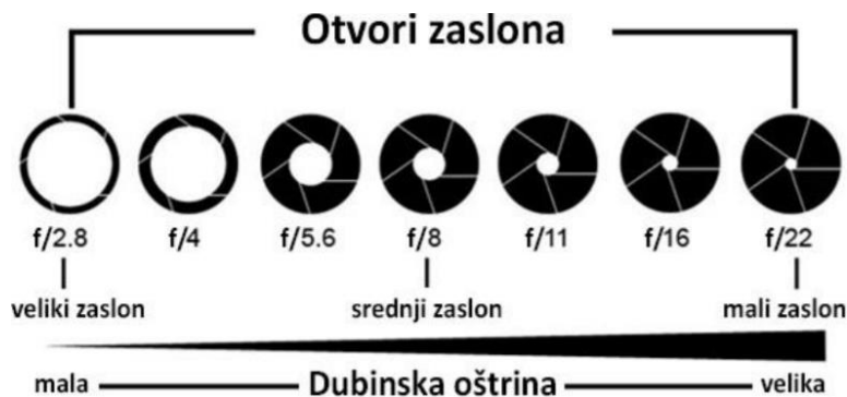
Slika 3-3 Standardni otvori zaslona, [22]
