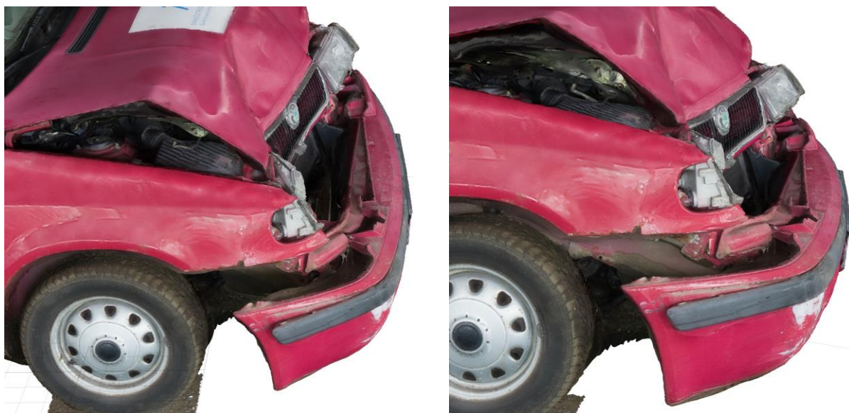
Slika 6-9 Prikaz mogućnosti fotogrametrije za određivanje oštećenja
