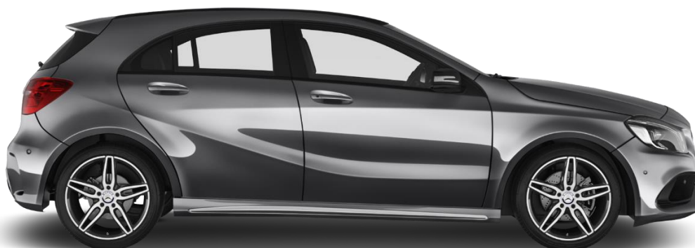
Slika 2-4 Primjer oblika karoserije sa zakošenim zadnjim vratima (engl. hatchback), [14]
