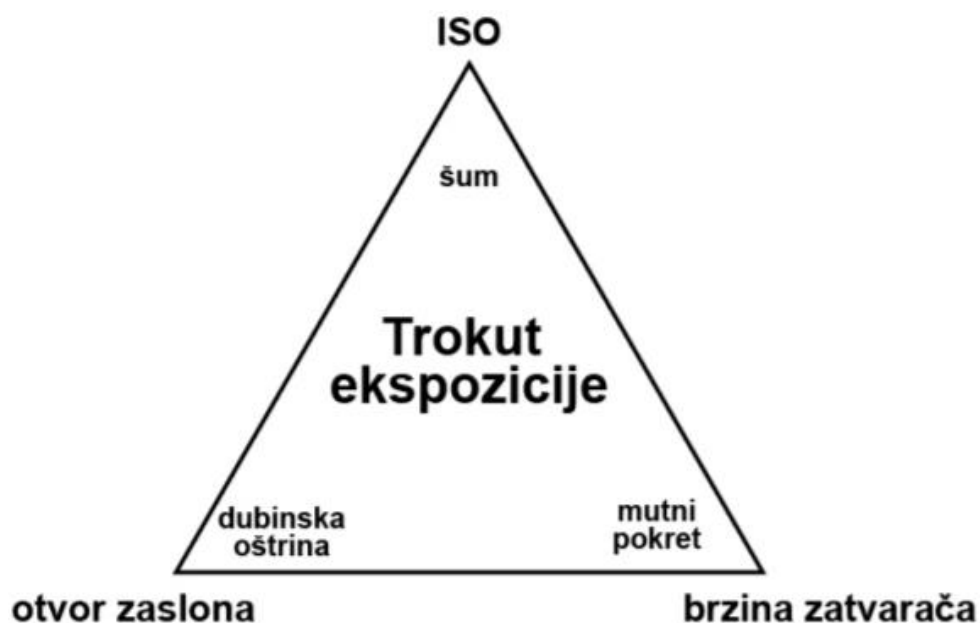
Slika 3-1 Međuviznost otvora zaslona - brzine zatvarača - ISO osjetljivost, [22]
