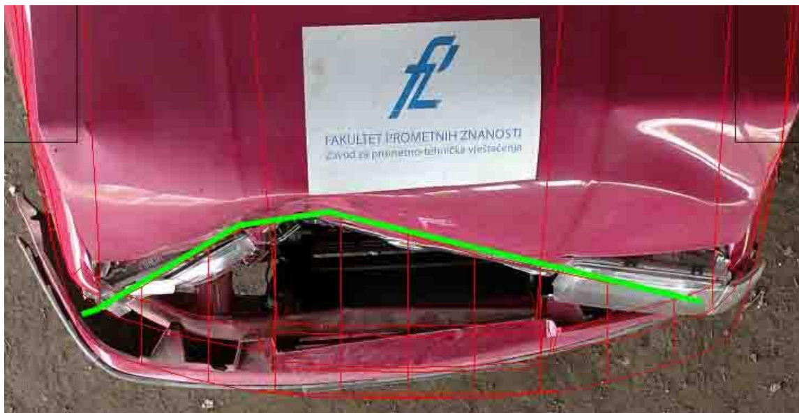
Slika 6-5 Prikaz dubine oštećenja na vozilu u PC-Crash programu
