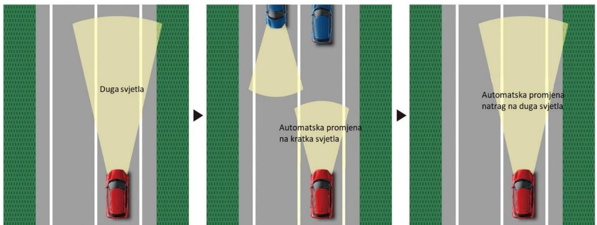
Slika 7. Princip rada automatskog paljenja dugih svjetala [13]
