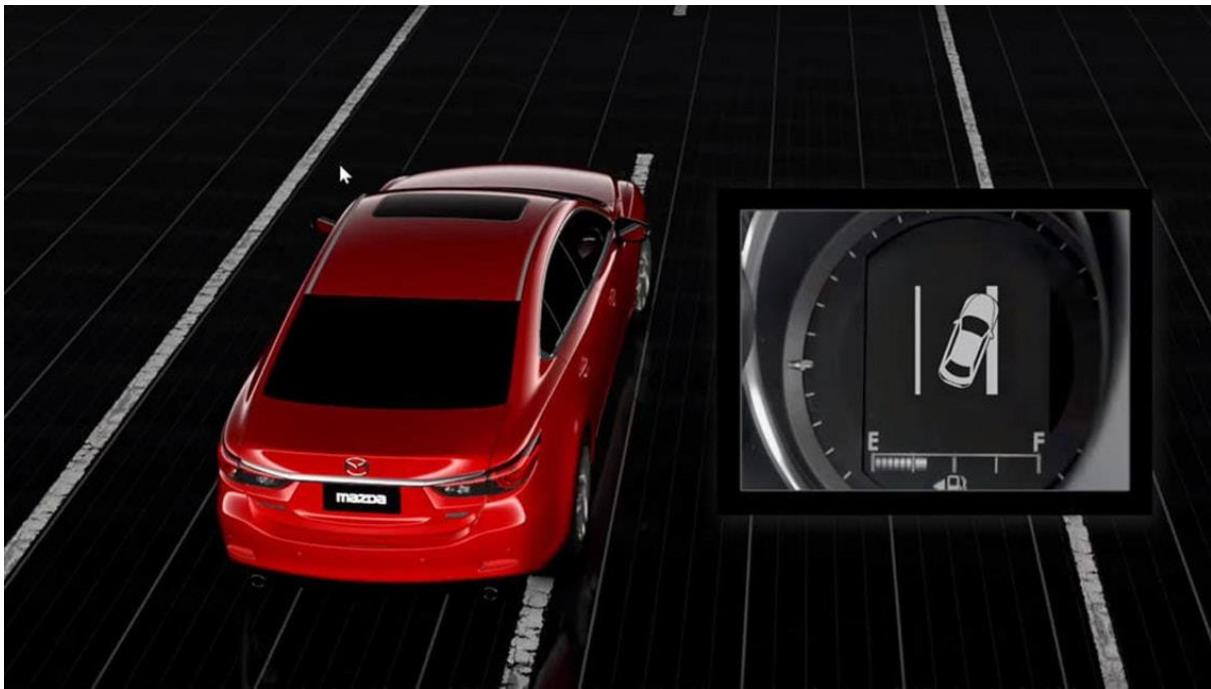
Slika 15. Funtcioniranje Lane Assist sustava na automobilu Mazda 6
