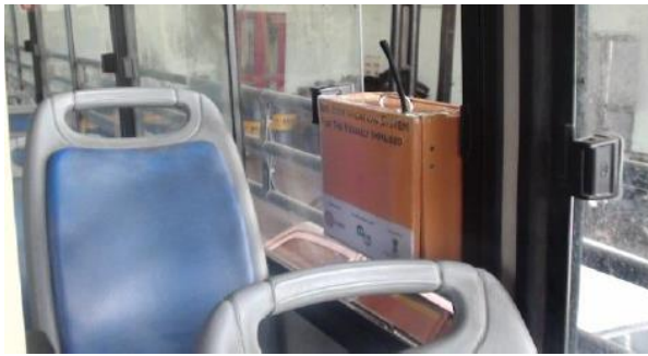
Slika 3. Prikaz modula zvučnika i antene
