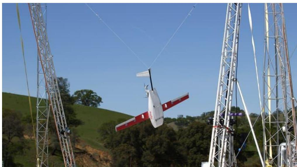
*Slika 6. Slijetanje drona prikačivanjem za kabel*
