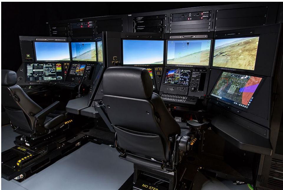
Slika 7. Zemaljska nadzorna stanica
