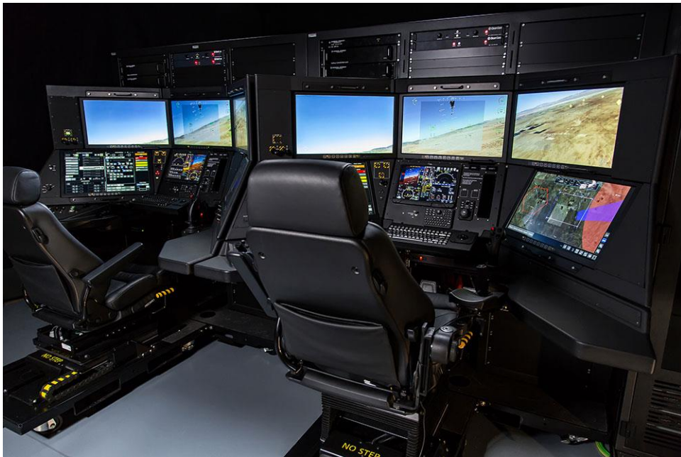
Slika 7. Zemaljska nadzorna stanica
