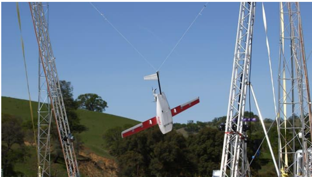
Slika 6. Slijetanje drona prikačivanjem za kabel
