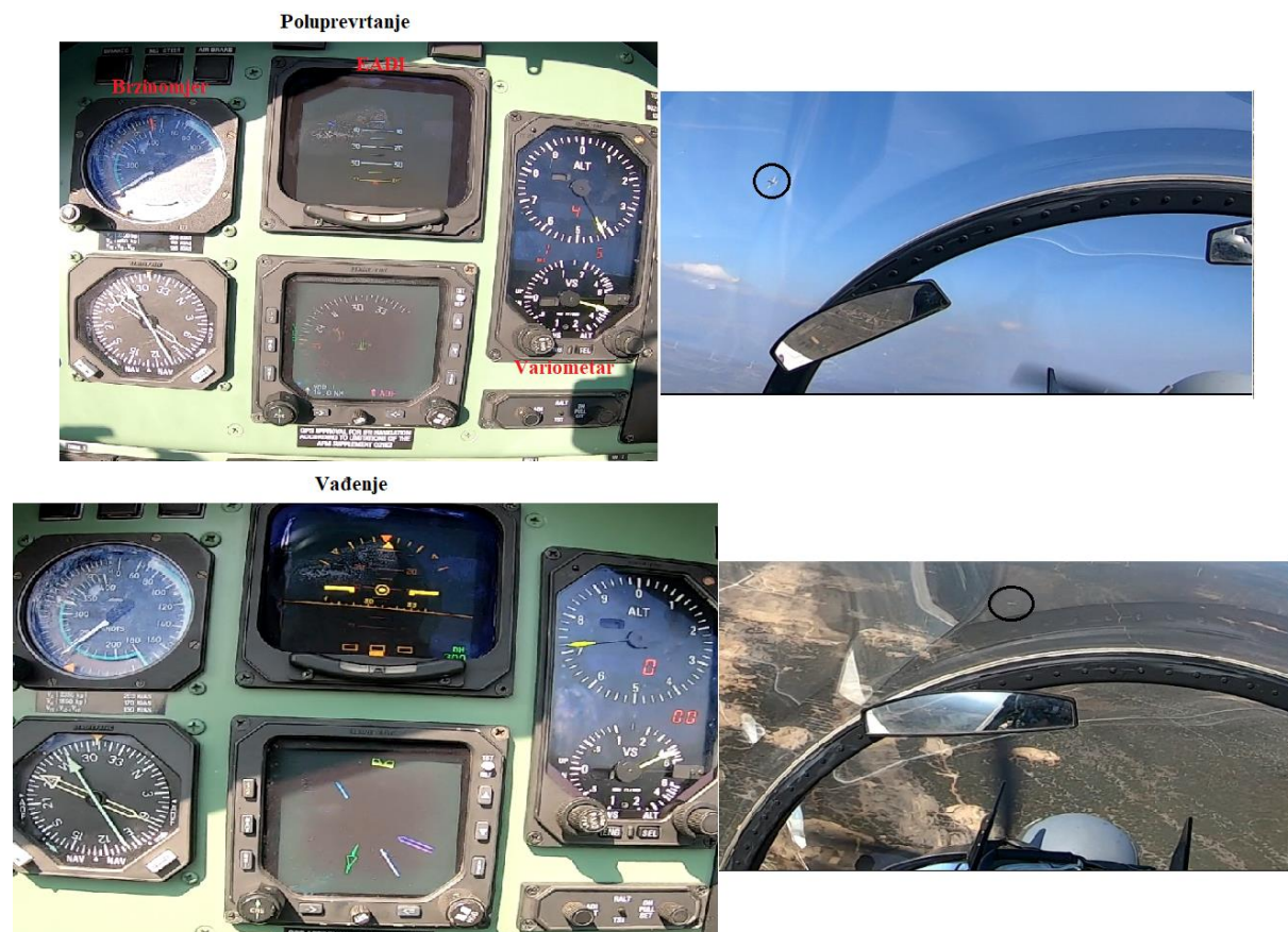
Slika 7.19. Pokazivanje instrumenata tijekom napada
