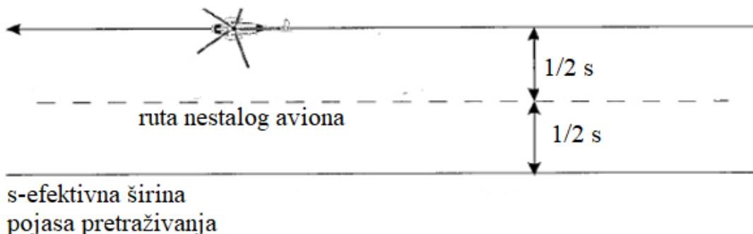
Slika 4.8. Metoda pretraživanja jednim preletom s povratkom, [27]
