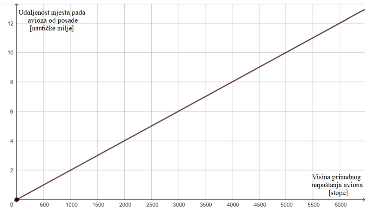
Grafikon 7. Udaljenost mjesto pada aviona od posade ovisno o visini prinudnog napuštanja aviona
