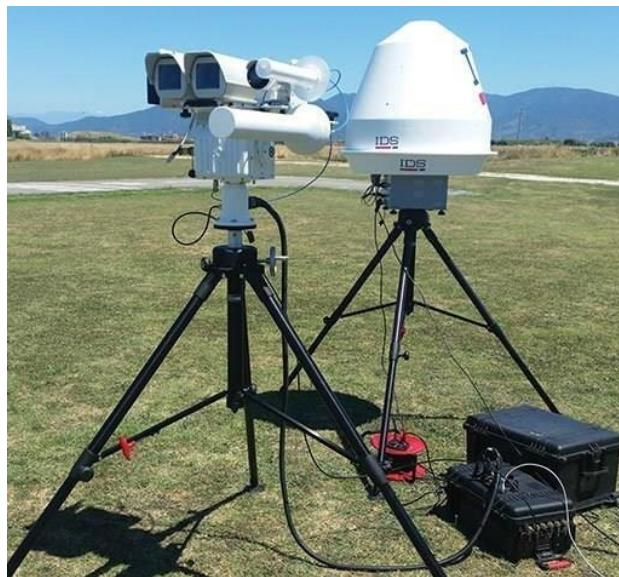
**Slika 29.** C-UAS radarski sustav detekcije, [54]
