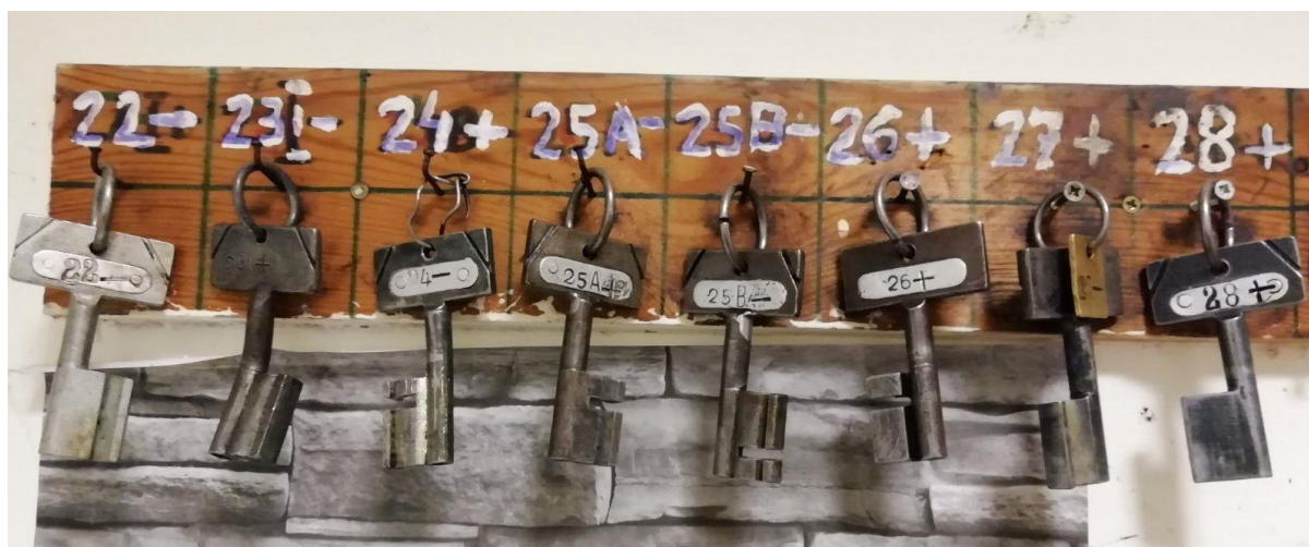
Slika 14. Ključevi skretnica od strane bloka 2
