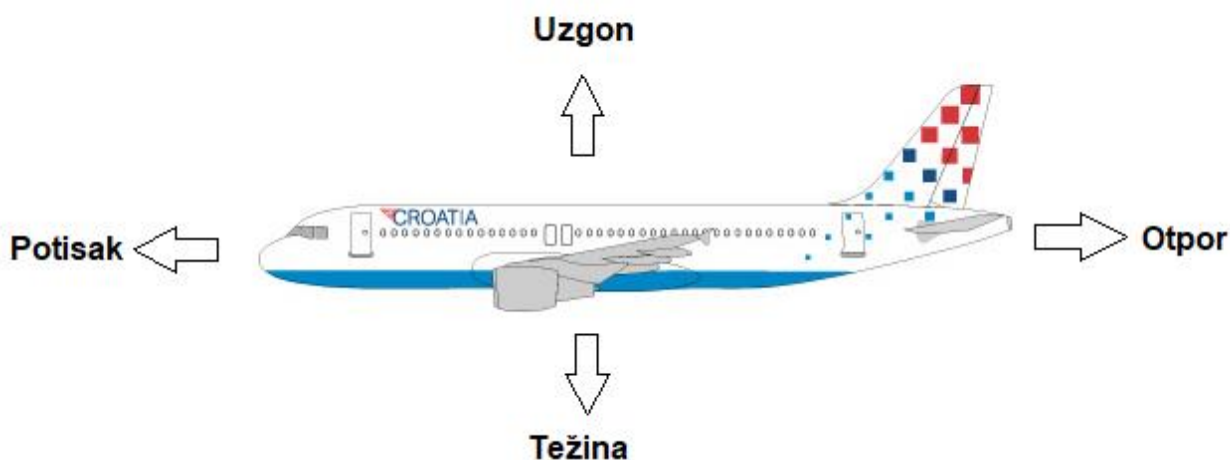
Slika 2. Sile koje djeluju na zrakoplov u horizontalnom letu, [9]
