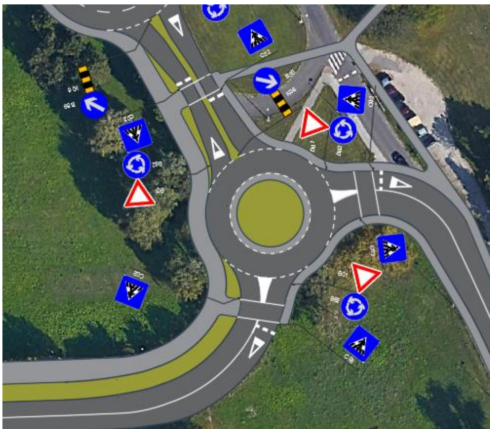
Slika 22. Prijedlog idejnog rješenja raskrižja Prisavlje - odvojak Av. M. Držića
