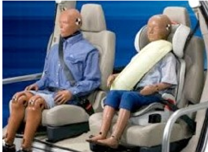
Slika 7. Sigurnosni pojas sa ugrađenim zračnim jastukom
