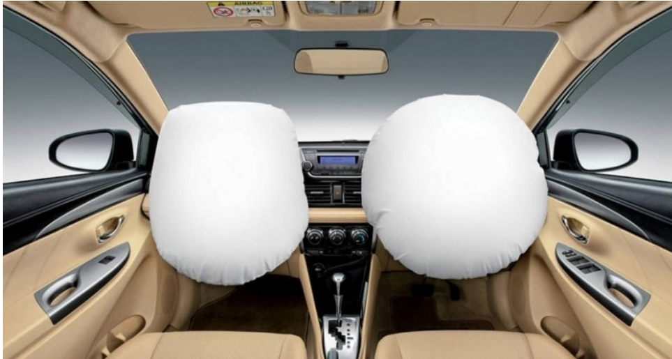
Slika 12. Aktivirani zračni jastuci u vozilu
