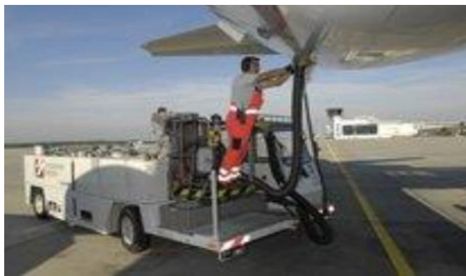
Slika 15. Servis otpadnih voda na zrakoplovu, [3]
