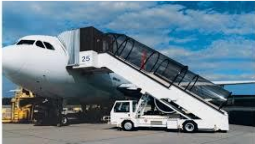
Slika 4. Proces postavljanja samohodnih putničkih stepenica na zrakoplov, [18]
