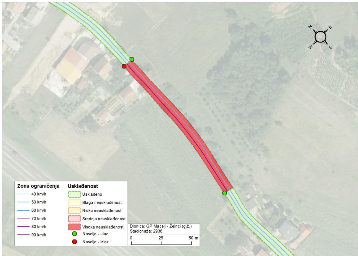
Slika 2. Primjer neusklađenih ograničenja brzine na DC1 - lokacija 2
