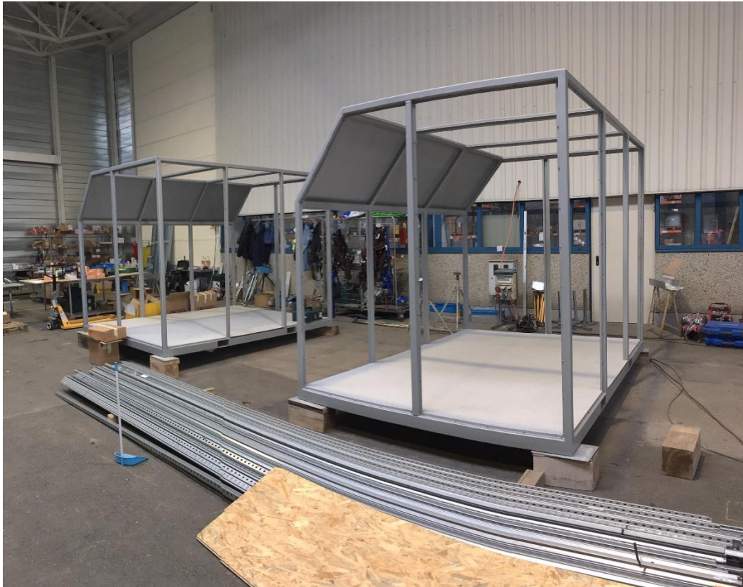
Slika 8. Konstrukcija okvira AMJ kontejnera, [20]
