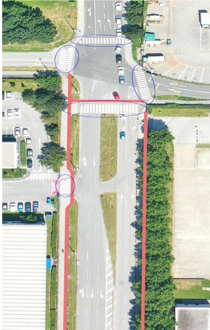
Slika 24 Prikaz infrastrukture pješačkog i biciklističkog prometa drugog predmetnog raskrižja
