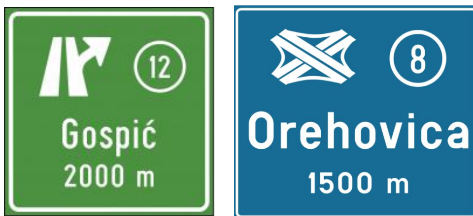
Slika 4. Predputokaz za izlaz s autoceste ili brze ceste s oznakom izlaza (D01) i predputokaz za interregionalno čvorište s oznakom čvorišta (D02)
