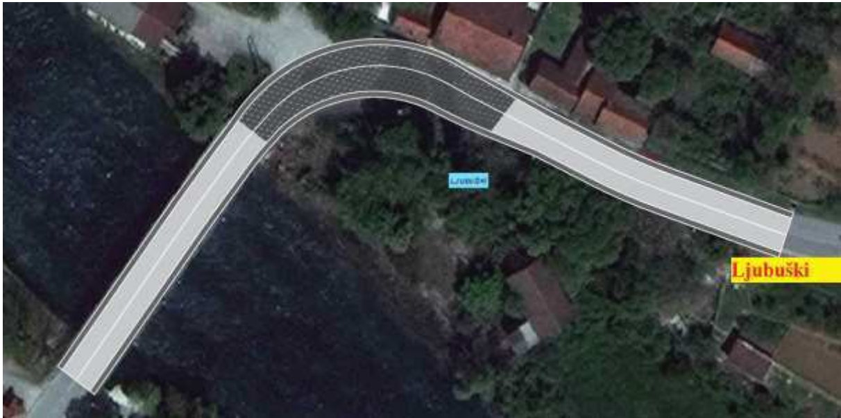
Slika 50. Idejno rješenje poboljšanja tlocrtnih elemenata dionice – Humac
