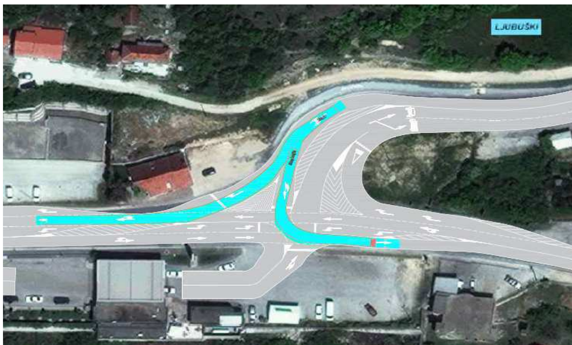
Slika 56. Trajektorija provoženja mjerodavnog vozila sa sporednog na glavni privoz – Raskrižje 2
