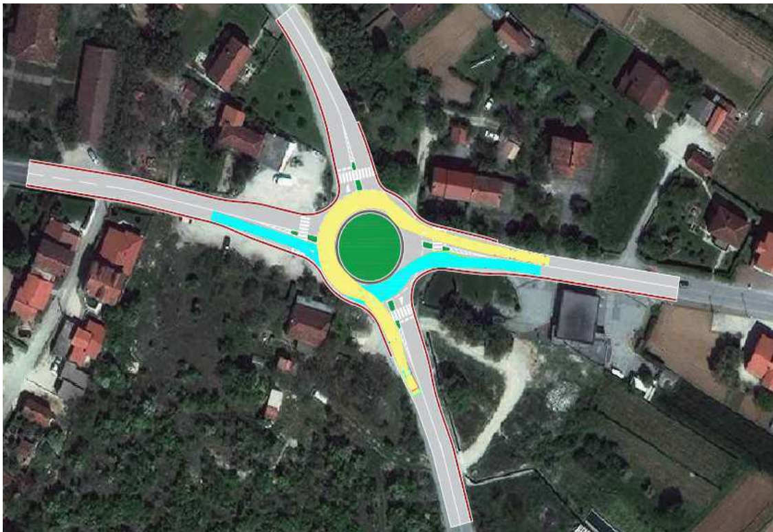
Slika 61. Trajektorije provoženja mjerodavnog vozila kroz raskrižje 6
