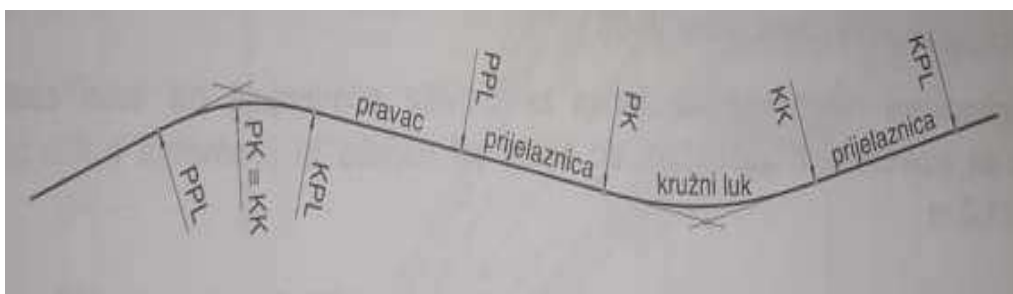
Slika 21. Izgled osi ceste u tlocrtu
