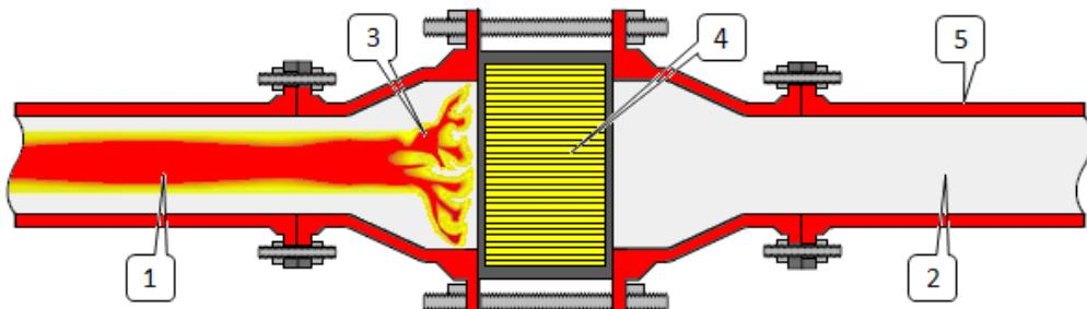
Slika 27. Prikaz hvatača plamena (1 – strana izložena plamenu; 2- štićena strana; 3 – plamen stabiliziran na hvataču plamena; 4- hvatač plamena apsorbira toplinu i gasi plamen; 5 – cijev)
