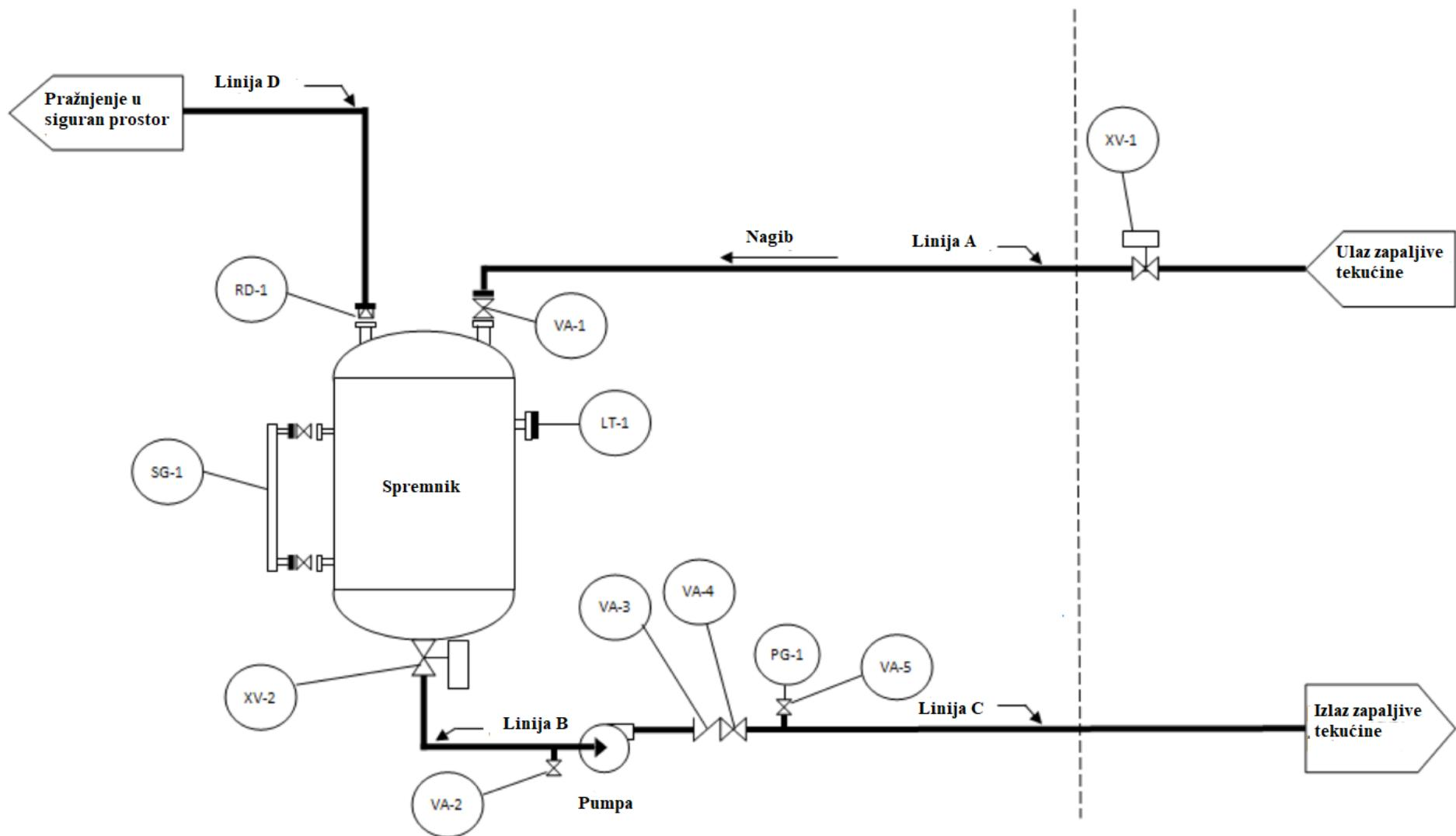
Slika 30. Primjer spremnika korištenog za skladištenje opasnih (zapaljivih) tekućih sirovina
