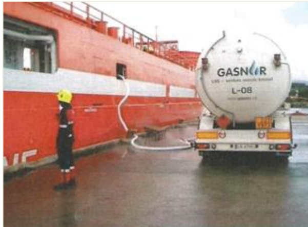
Slika 12. Primjer preuzimanja UPP-a načinom kamion cisterna - plovilo Izvor:
