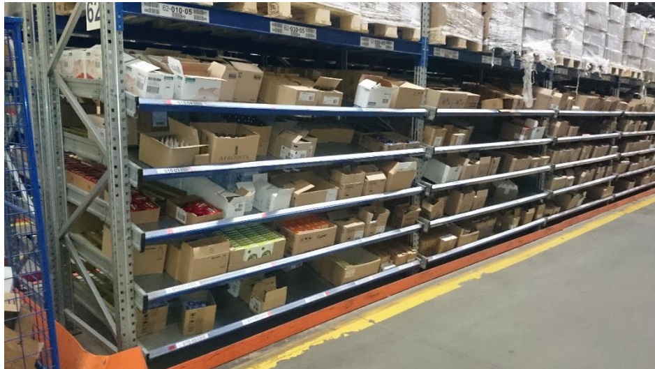
Slika 2.8. Prikaz prednje strane gravitacijske protočne police (strana s koje se artikli komisioniraju)
