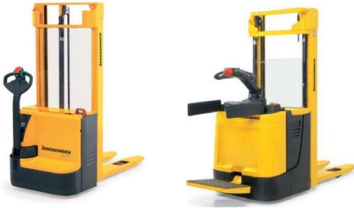
**Slika 2.13.** Prikaz izvedbi motorno- ručnih viličara s teleskopom
