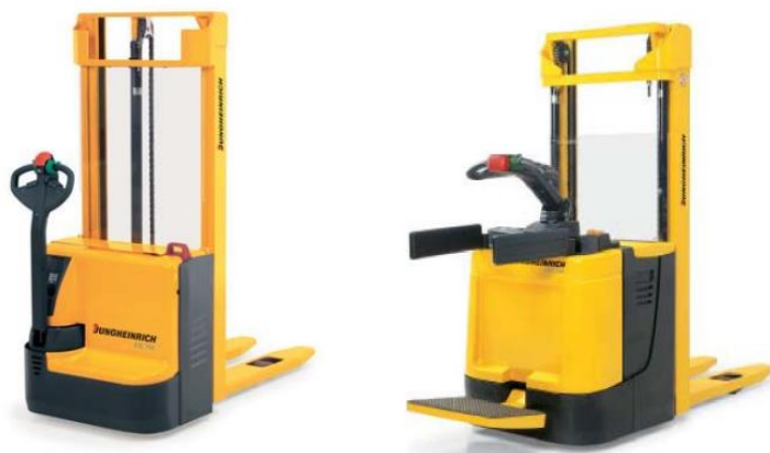
Slika 2.13. Prikaz izvedbi motorno- ručnih viličara s teleskopom
