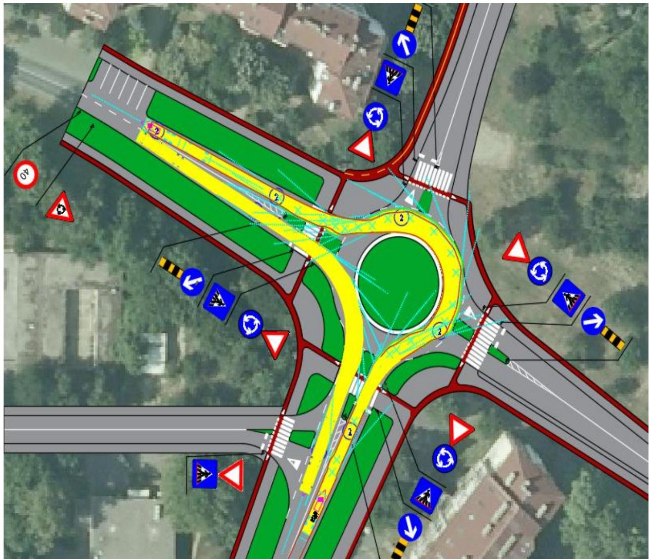
**Slika 35.** Prikaz trajektorije mjerodavnog vozila na raskrižju 3
