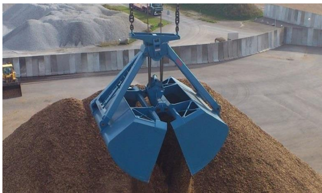
Slika 23. Zatvorena zahvatna grabilica
