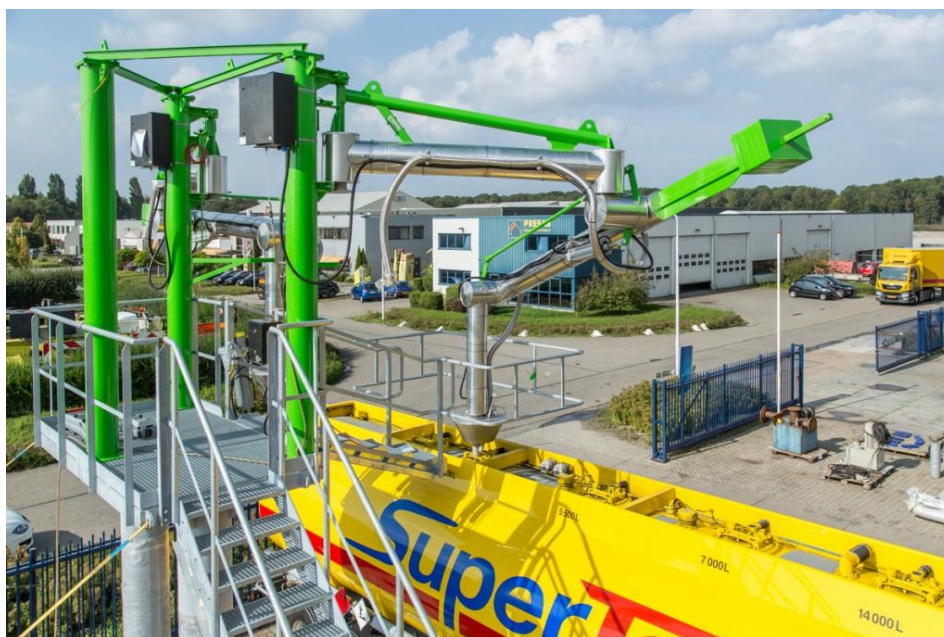
Slika 68. Ukrcaj tekuće rasute biomase za transport cisternom
