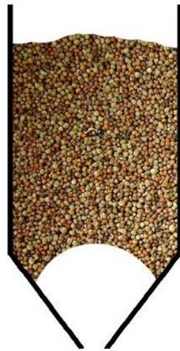
Slika 74. Problem zasvođavanja biomase unutar lijevka
