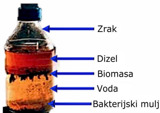
Slika 72. Degradacija tekuće tekuće biomase
