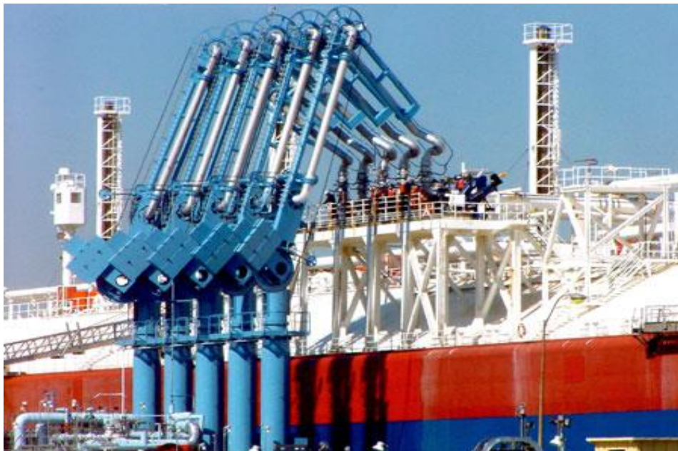
Slika 62. Prekrcaj tekuće rasute biomase sa pretakačkim rukama
