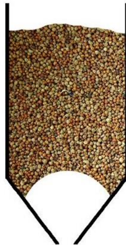
Slika 74. Problem zasvođavanja biomase unutar lijevka
