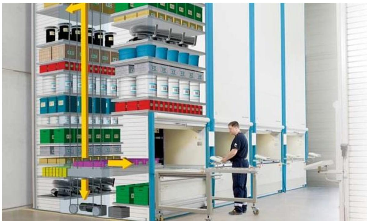
**Slika 14 Prikaz vertikalnog podiznog modula**
