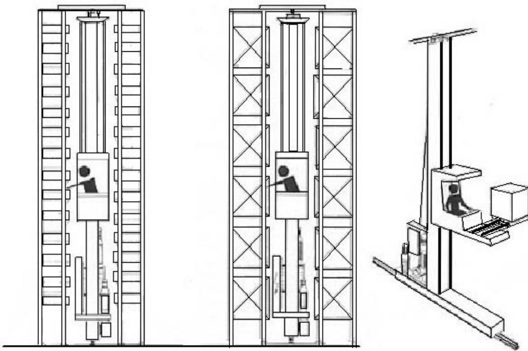
**Slika 6 Automatizirano skladište za komisioniranje (Man on board AS/RS)**
