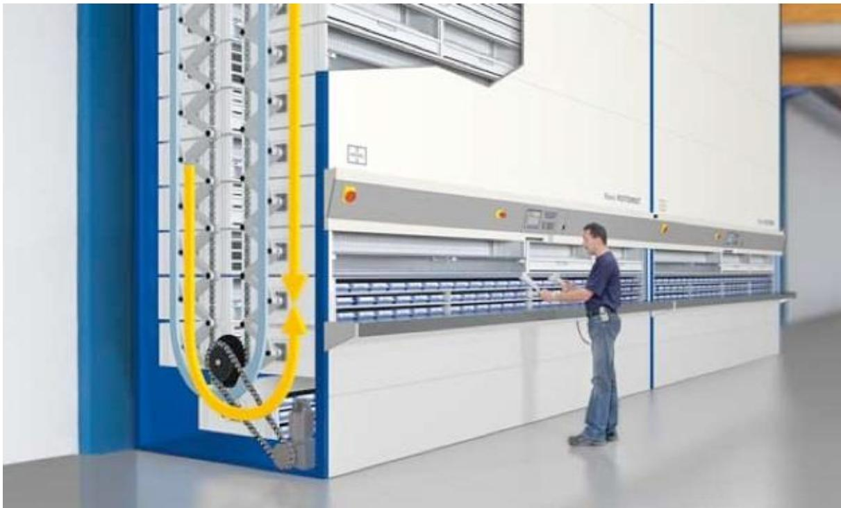
**Slika 13 Prikaz vertikalnog karusela**
