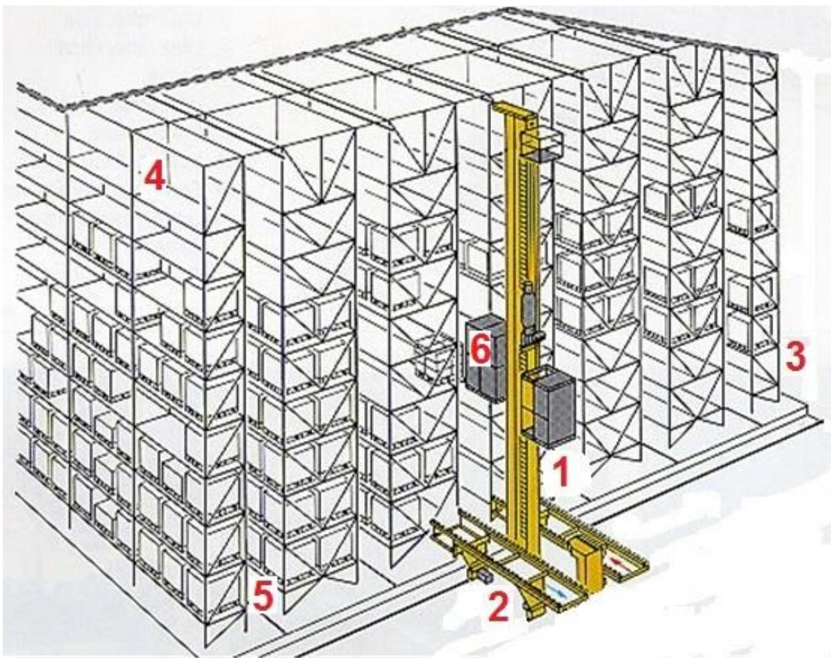
**Slika 4 Prikaz visokoregalnog automatiziranog sustava sa pripadajućim komponentama**
