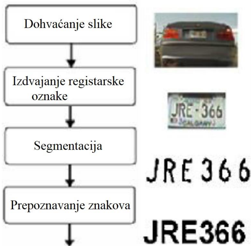
Slika 8. Princip rada ANPR sustava
