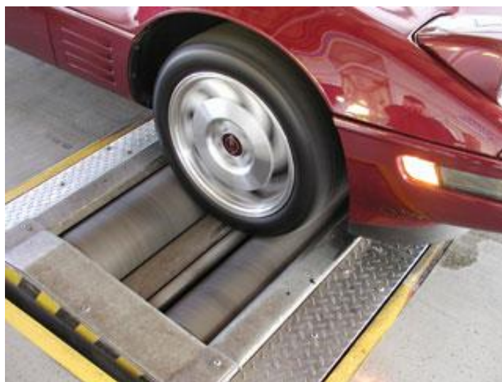
Slika 1. Valjci za ispitivanje kočne sile (Izvor: [6])
