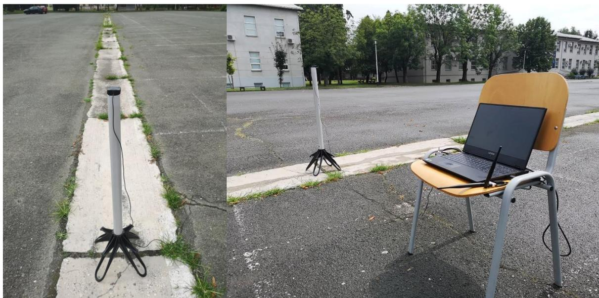
Slika 12. Prikaz RTK bazne stanice spojene na računalo
