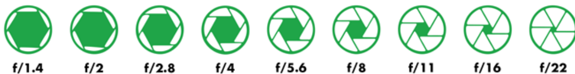
Slika 24. Veza otvora blende i veličine f , [19]
