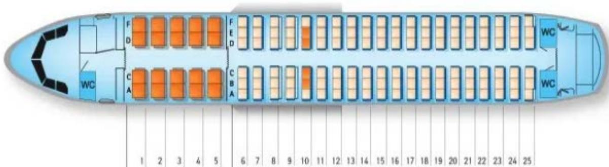
**Slika 4.** Shematski prikaz sjedala u kabini zrakoplova A320, [6]
