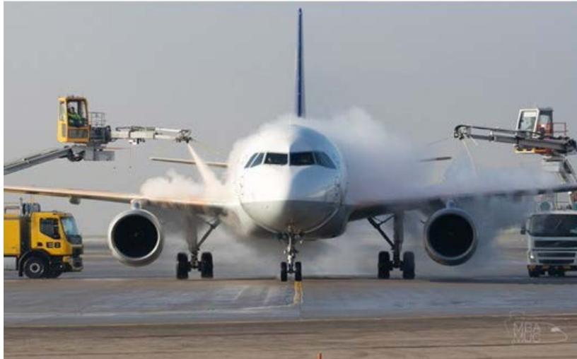
**Slika 9.** Odleđivanje zrakoplova A320-214 u Munchenu, [8]
