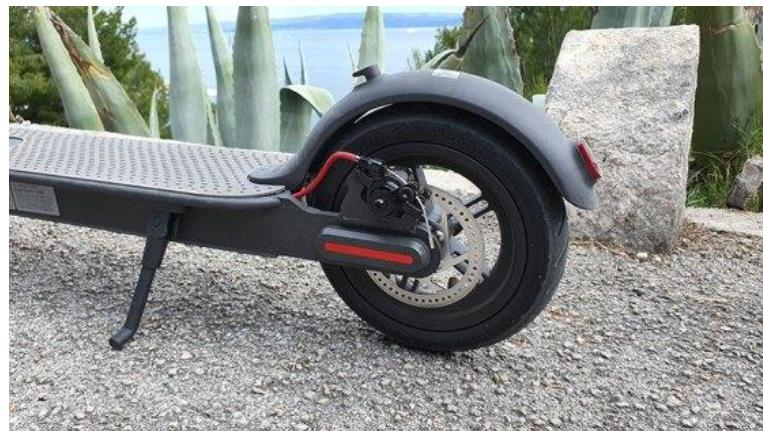
*Slika 6. Disk kočnica električnog romobila*
