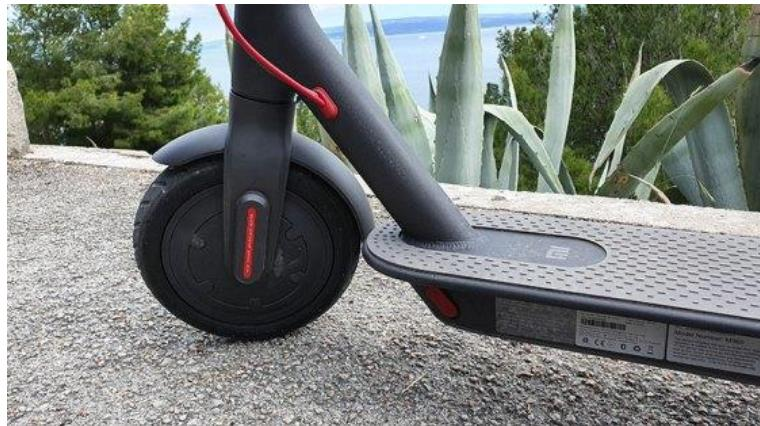
*Slika 5. Motor električnog romobila smješten na prednjem kotaču*
