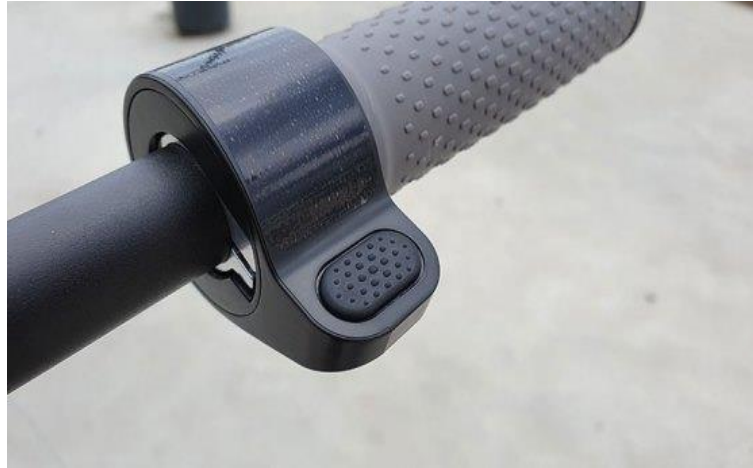
Slika 4. Ručica za podešavanje brzine
