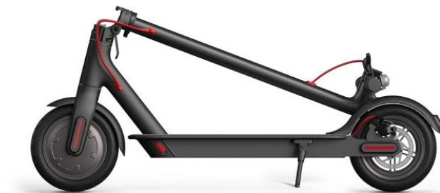
Slika 8. Mogućnost sklapanja električnog romobila
