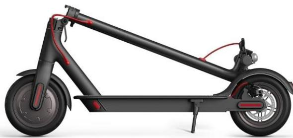
*Slika 8. Mogućnost sklapanja električnog romobila*
