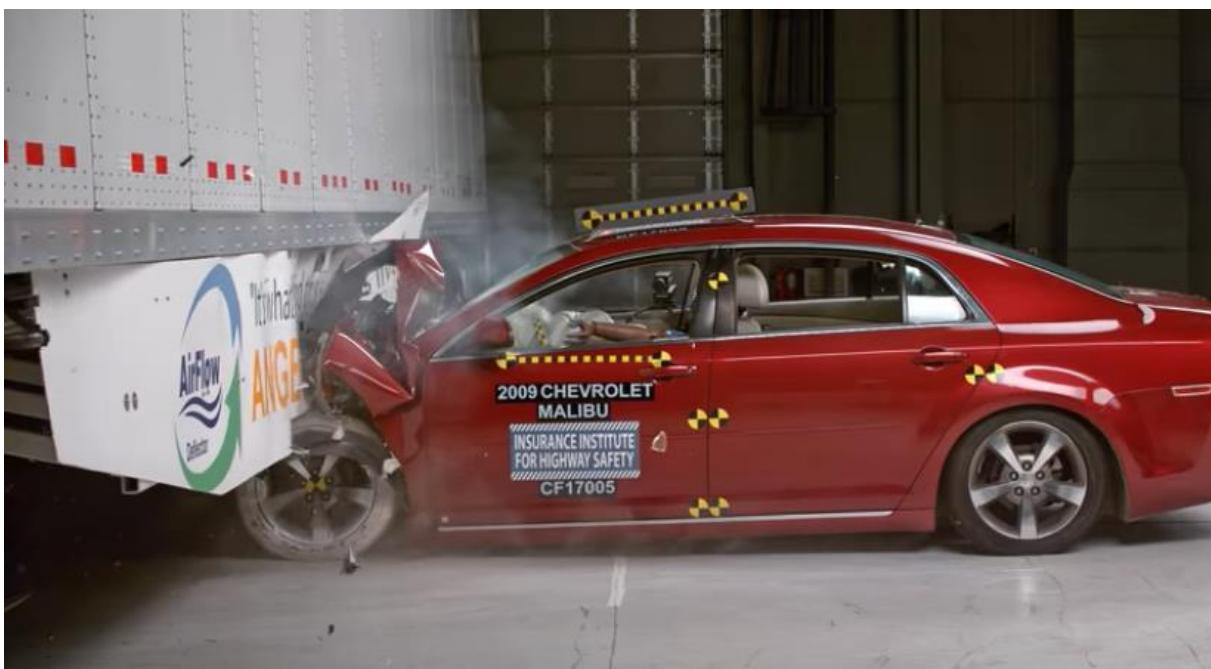
Slika 34: Utjecaj bočne zaštite od podlijetanja
