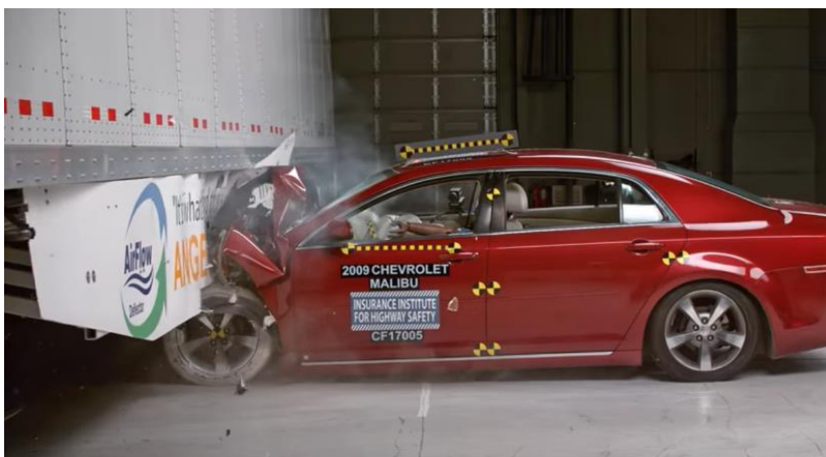
Slika 34: Utjecaj bočne zaštite od podlijetanja
