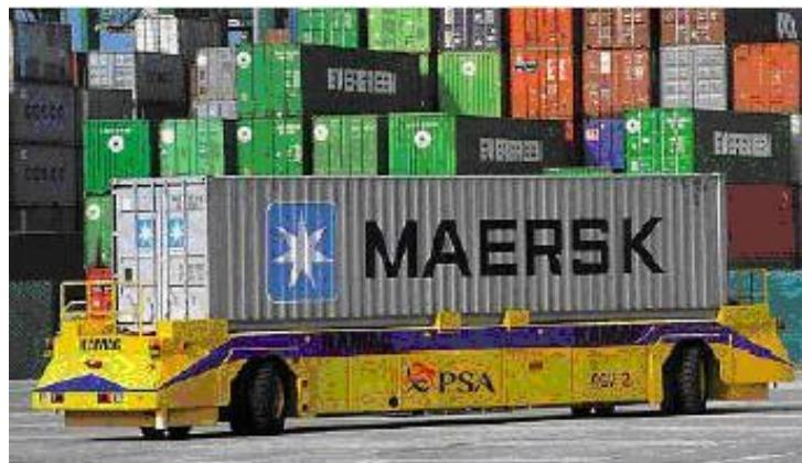
**Slika 11. Automatski vodeno vozilo za transport kontejnera**
