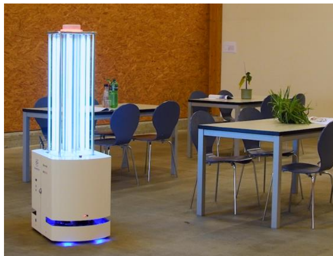
Slika 7. Dezinfekcijski uređaj na bazi UV spektra svjetlosti na zračnoj luci u Napulju, [26]
