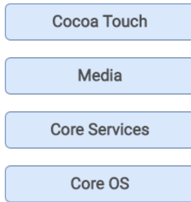
Slika 5. Arhitektura iOS operativnog sustava
